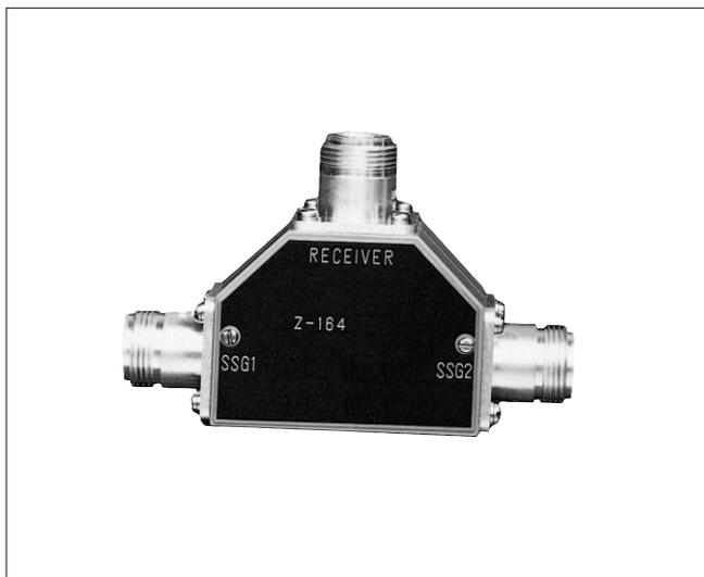
Z-164A/Bは、受信機の二信号特性(感度抑圧効果、相互変調特性など)を測定する場合に、受信機の入力端子に2台の標準信号発生器の出力を混合して加えるための整合器として用いられます。Z-164Aは50系に、Z-164Bは75系に適合します。
