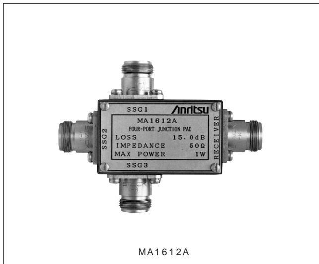
MP659A、MA1612Aは受信機の三信号特性(SINAD法による相互変調特性)を測定するときに、3台の信号発生器の出力を合成し、受信機に供給するための整合器として使います。
